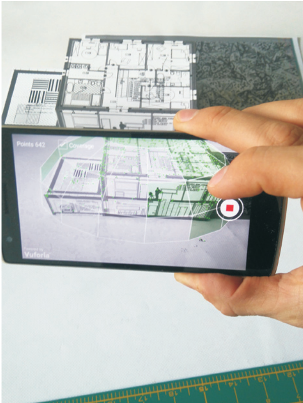
Ryc. 4. Proces zapamiętywania i rozpoznawania fizycznego modelu poprzez kamerę za pośrednictwem systemu Vuforia; źródło: fot. autor, platforma Vuforia
