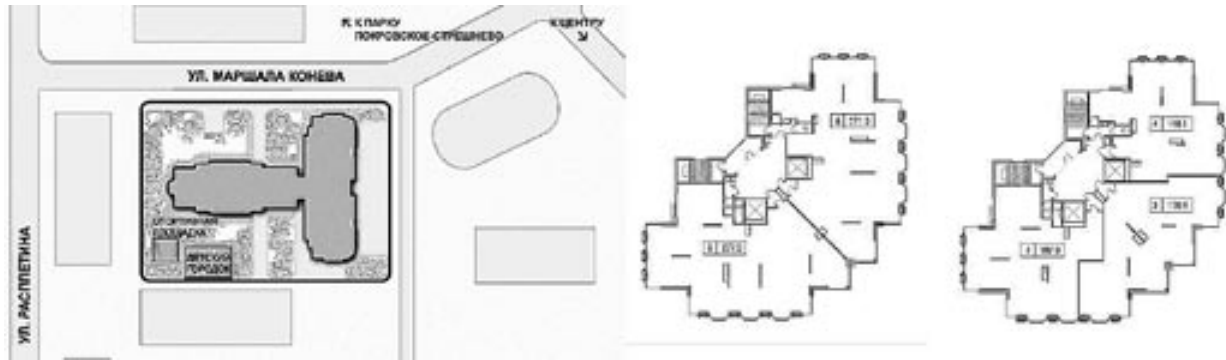
Ryc. 9. „Siewiernaja zwiezda”, zagospodarowanie terenu i plany kondygnacji 5-23, 28 oraz 24-27, www.donstroy.com
