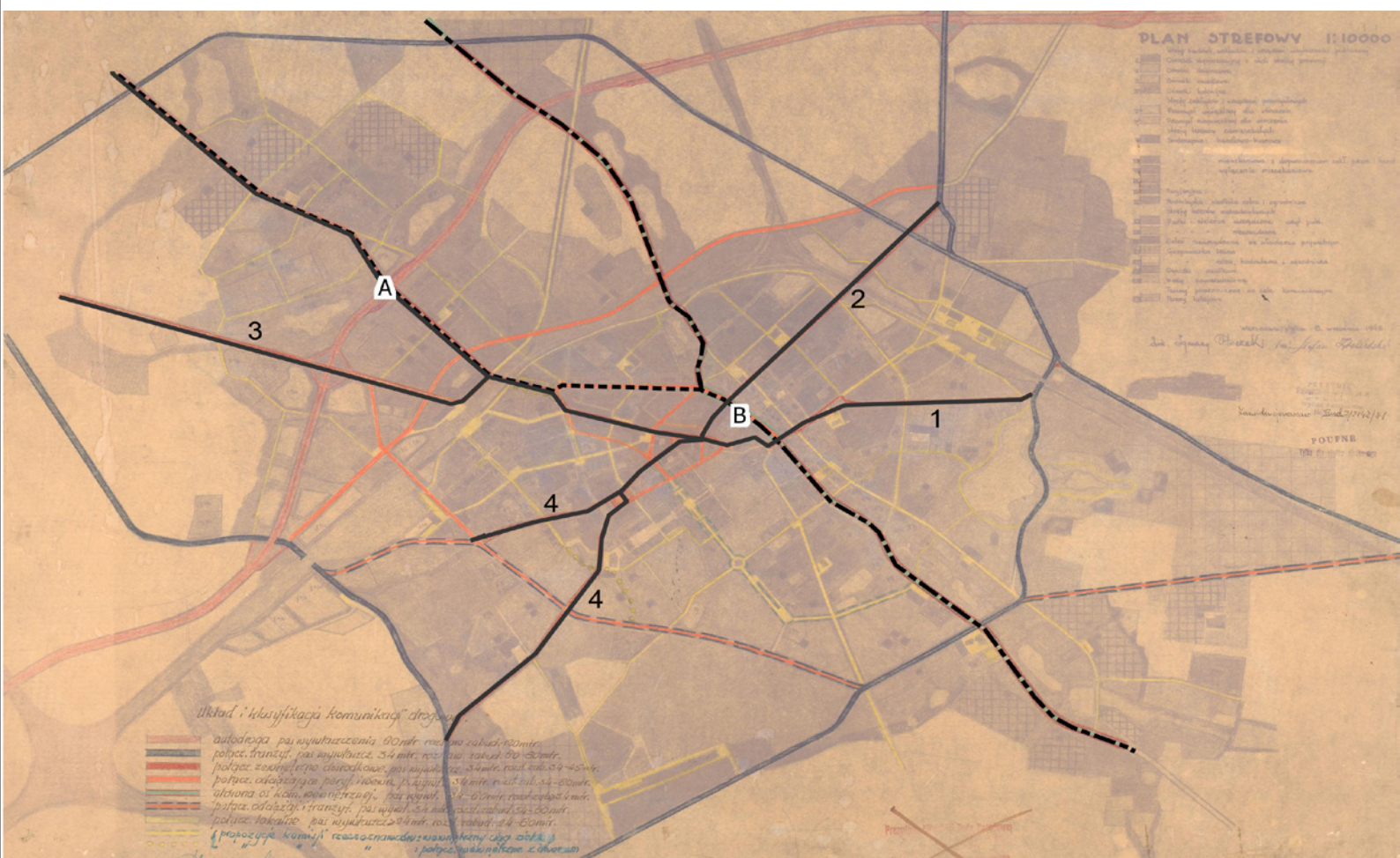
Ryc. 2. I.F. Tłoczek, St. Zieliński, Program ogólnego zagospodarowania przestrzennego miasta wojewódzkiego Białegostoku, 1948 r., układ i klasyfikacja komunikacji drogowej; elementy analiz oprac. M. Chodorowski: A - przebieg głównej osi miasta w kierunku Fast; B - pierwotny przebieg głównej osi uwarunkowany równoległym przebiegiem do rzeki; 1 - arteria dośrodkowa (ul. Słonimska i Piasta); 2 - arteria dośrodkowa (ul. Sienkiewicza); 3 - arteria dośrodkowa (ul. Zwycięstwa, aleja Jana Pawła II); 4 - arteria dośrodkowa (ul. Młynowa z odgałęzieniem ul. Mazowieckiej)
